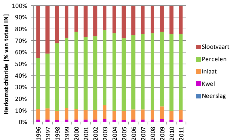
Figuur 4.40 Herkomst inkomend chloride in g/m 3 als percentage van de post IN op jaarbasis voor afdeling 1 van de Wieringermeer (berekening oppervlaktewaterbalans).
