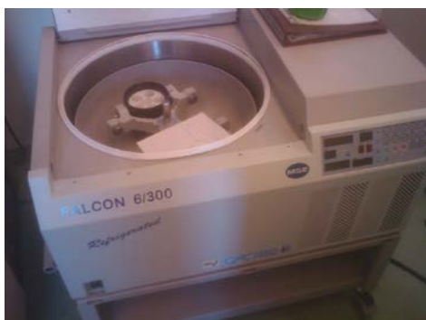
Figuur 3.7. Centrifuge waarmee de water uit de bodemmonsters is verkregen.
