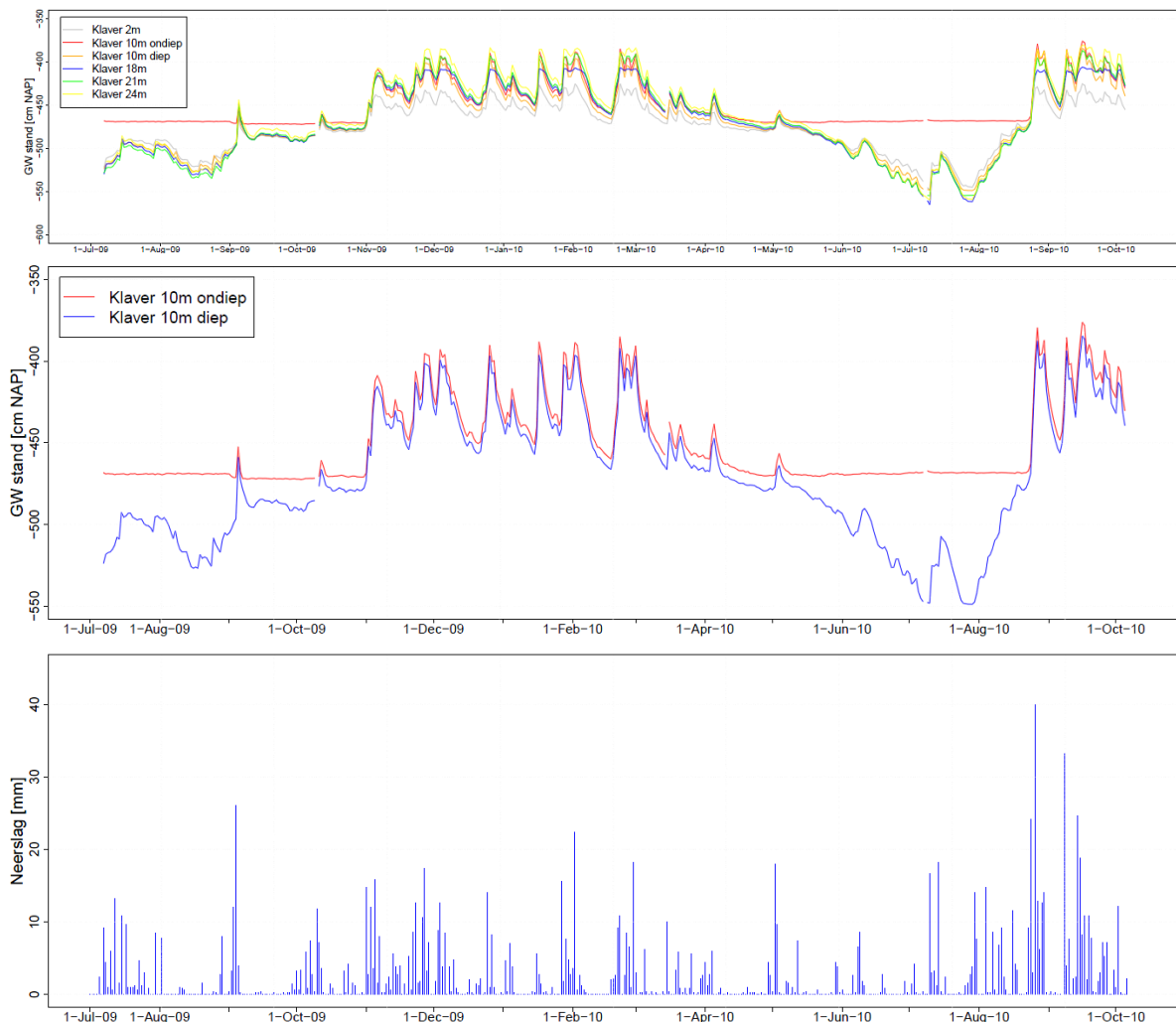
Figuur 3.40 Gemeten verloop van de grondwaterstand in diepe en ondiepe filter voor alle peilbuizen (boven) en peilbuis 10a/b (midden). Het maaiveld ligt bij peilbuis 10 op ongeveer -382cm NAP. Daaronder een grafiek met het gemeten verloop van de neerslag gemeten met de regenmeter.
