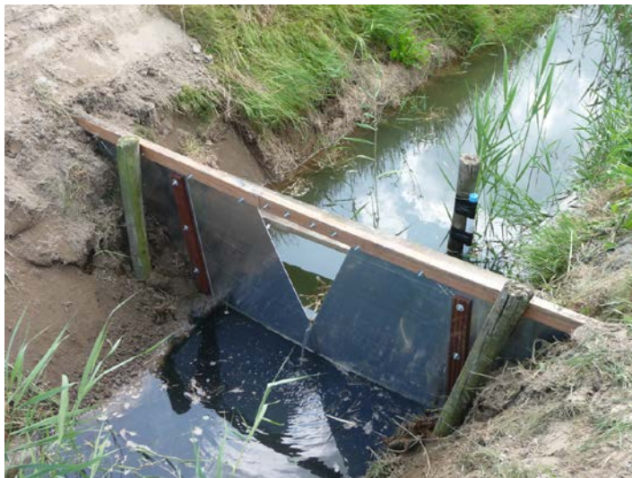
Figuur 3.12 Schot in sloot met ctd-diver (Wieringermeer, perceel Visser).
