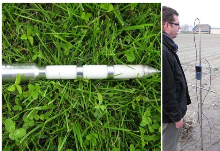
Figuur 3.5 Prikstokpunt en gebruik prikstok
