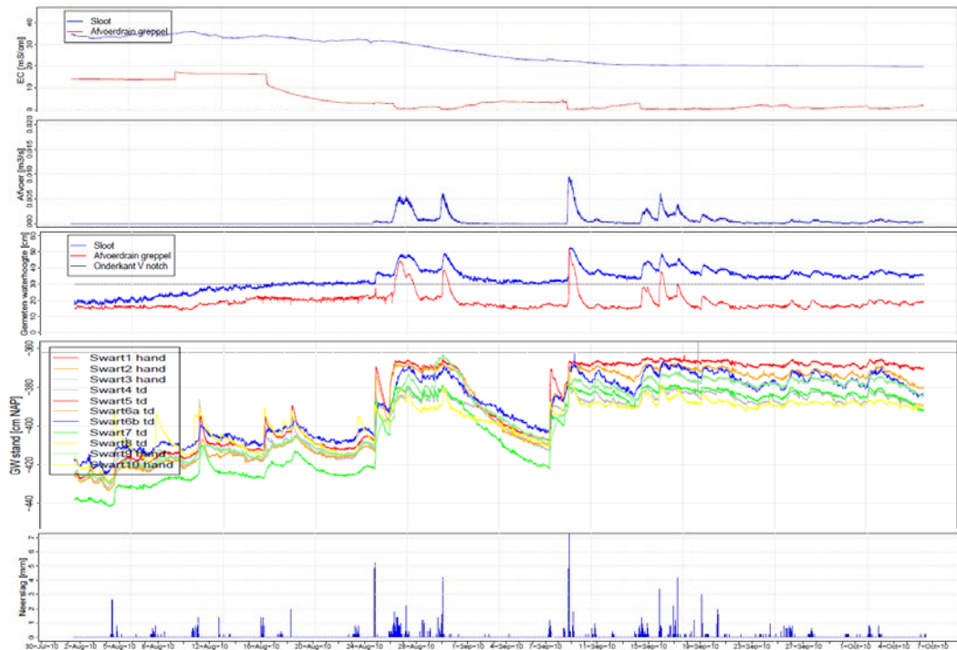
Figuur 3.23. Van boven naar beneden: EC drain en sloot [mS/cm] (a); Afvoer in de sloot [m 3 /s] (b); Waterstand in de sloot (greppel is relatieve waarde) [cm NAP] (c); Grondwaterstand [cm NAP] (d) en Neerslag [mm] (e) op perceel Swart juli-oktober 2010.
