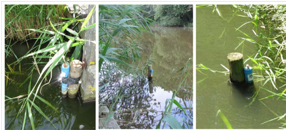
Figuur 3.9 CTD-divers in watergangen
