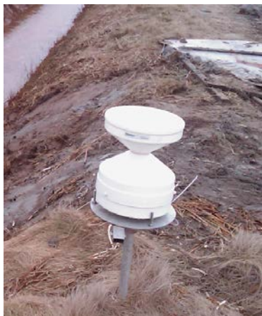
Figuur 3.13 Regenmeter op het perceel in de Wieringermeerpolder
