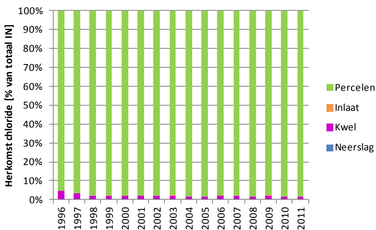
Figuur 4.42 Herkomst inkomend chloride in g/m 3 als percentage van de post IN op jaarbasis voor afdeling 4 van de Wieringermeer (berekening oppervlaktewaterbalans).
