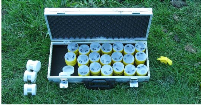
Figuur 3.6. In de koffer de monsterringen luchtdicht verpakt met tape.
