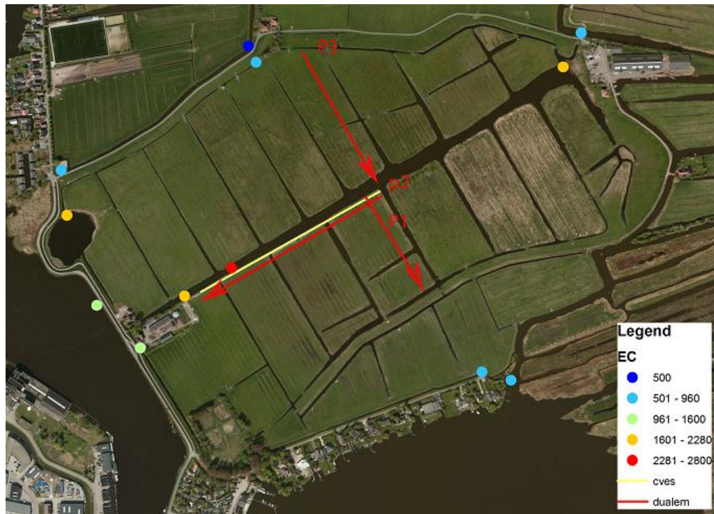
Figuur 4. Gedetailleerd overzicht van de uitgevoerde geofysica metingen . Tevens weergegeven de resultaten van de EC-metingen in het oppervlaktewater.
